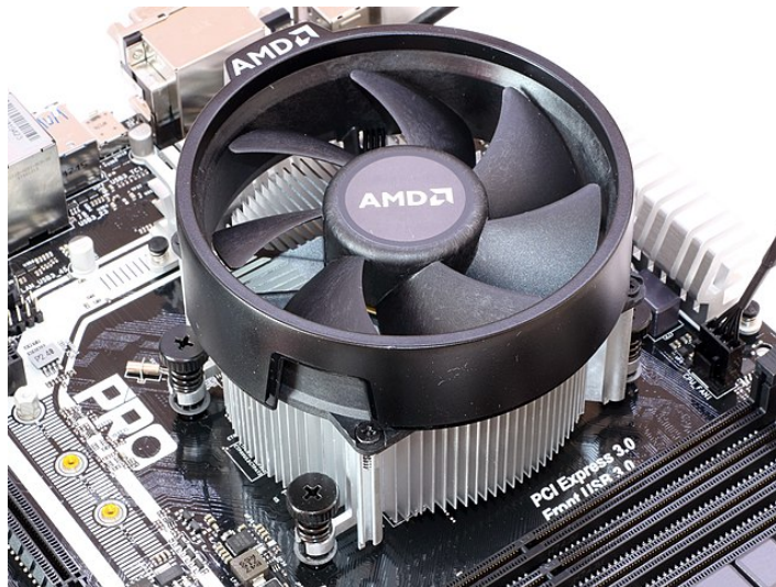
Figura 5: Disipador de calor y ventilador instalado sobre un procesador marca AMD.
